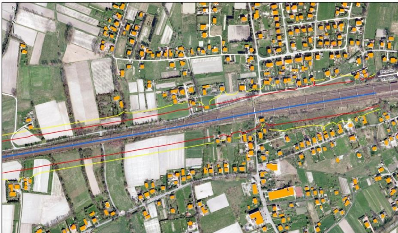
Rysunek 10. Mapa akustyczna dla wskaźników oceny hałas LDWN i LN w rejonie badań linii kolejowych nr 93 i 157 na terenie Gminy Chybie w 2015 roku (fragment B).
